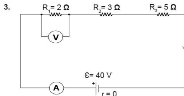
Şekildeki devrede anahtar kapatıldığında ampermetre ve voltmetrenin gösterdiği değerler hangi seçenekte doğru verilmiştir? (Ampermertenin iç direnci sıfırdır.)
