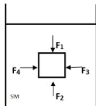
Sıvı içerisinde dengelenmiş küp şeklindeki cismin yüzeylerine uygulanan basınç kuvvetleri şekilde gösterilmiştir. Cismin ağırlığı  $G$ , kaldırma kuvveti  $F_k$  olduğuna göre;
